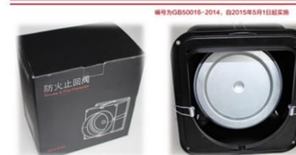
防火止回阀是一种自动阀门，其原理是防止油烟倒灌，只允许油烟向一个方向流动，而且阻止油烟反方向流动。当油烟机开始工作时，带有油烟的气流通过进风口和导流曲面，推开单向阀片，将油烟排入公共烟道；当油烟机停止工作时，单向阀片在重力作用下自动关闭，将烟管与公共烟道相隔离，公共烟道内的油烟不会倒灌进来，达到防止倒烟串味的功能。同时防火止回阀采用金属材质，配有防火机构，当烟道内起火时防火机构会强制关闭阀门，阻止烟道内的火通过烟管向室内蔓延。
