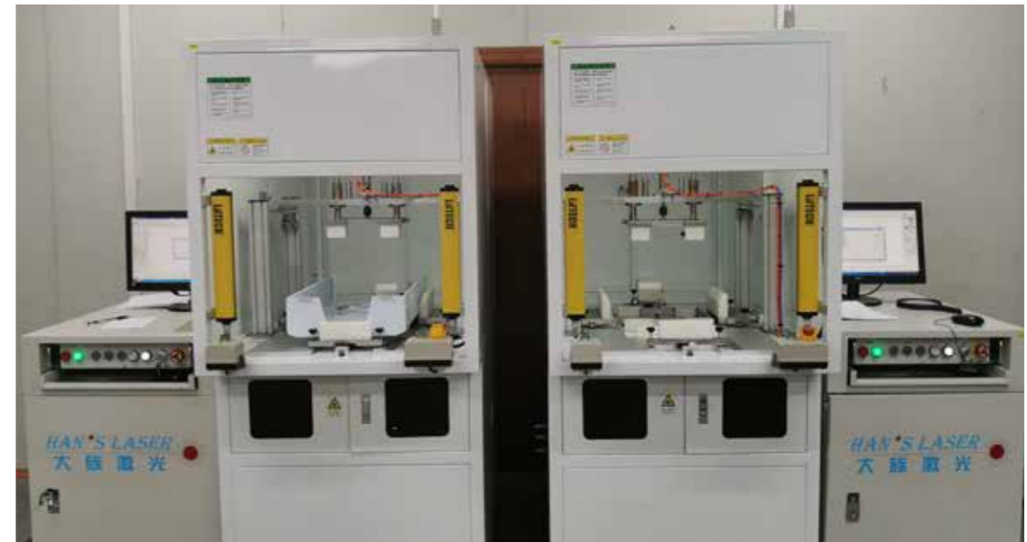
使用先进的激光打标工艺替代传统有害的油墨丝印工艺，改善员工作业环境
